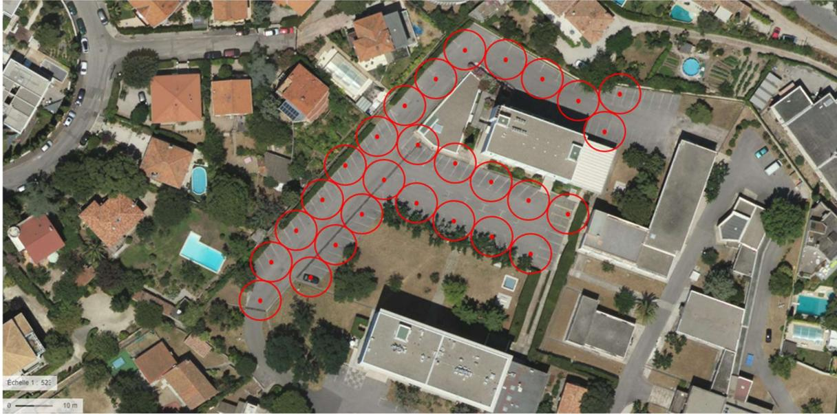
**Figure 3 : Schéma de principe de l'implantation des 27 sondes géothermiques (extrait de l'étude de faisabilité)**
